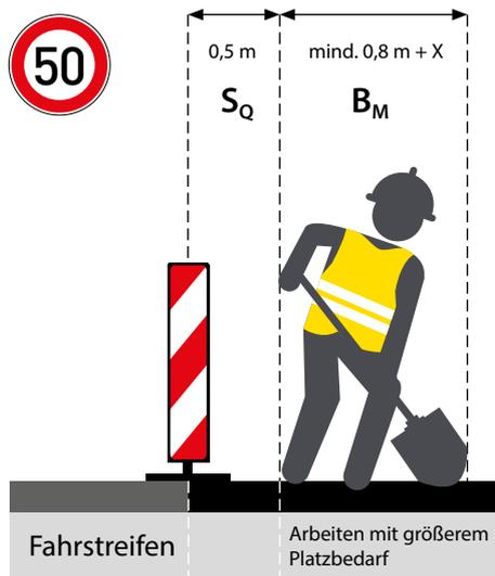
Beispiele der Bemessung von  $S_Q$  und  $B_M$  nach ASR A5.2 (Bild 2).
